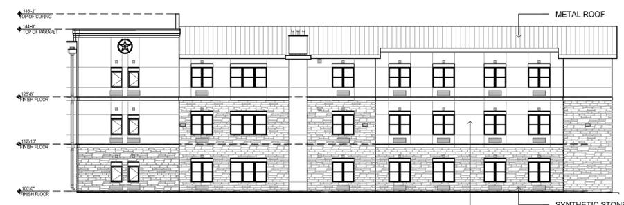
**B1 BUILDING B - EAST ELEVATION**
