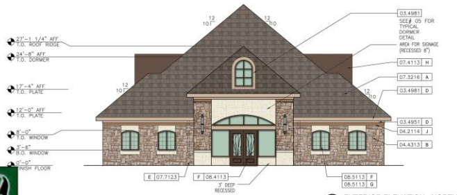
02 EXTERIOR ELEVATION - NORTH SCALE: 1/8" = 1'-0"
