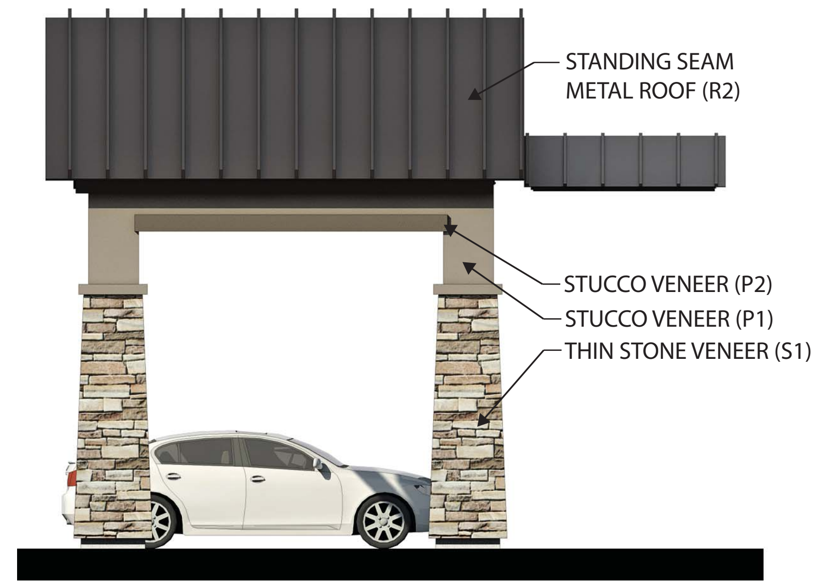
07 WEST PORTE COCHERE - SIDE ELEVATION N.T.S.
