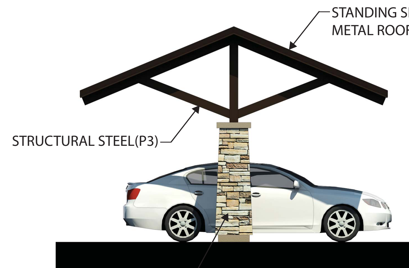
02 CARPORT SIDE ELEVATION N.T.S.
